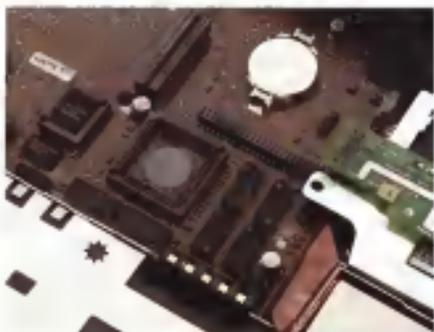
Particolare della motherboard: si notano in alto a sinistra il connettore per il modem, in alto a destra la batteria di riserva, sotto a questo il connettore per l'installazione di ISA, ed infine in basso per il processore.
